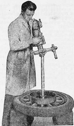
Рис. 4. Установка приспособления с мотором на центральный шпиндель
